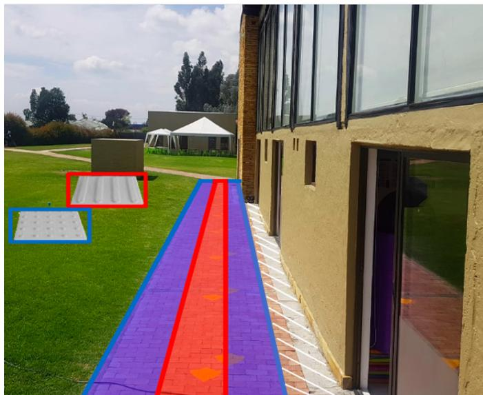
*Nota.* Al igual que en la figura 22, en esta propuesta se hace uso de las baldosas podotáctiles en una parte del sendero, teniendo en cuenta, que hay un espacio que no se puede usar, debido a que tiene una parte de la pared desalineada, como se ve en la figura, con el resto de la fachada de la estructura que se encuentra al costado del sendero.
