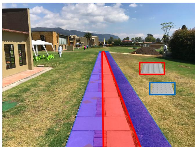
*Nota.* En este sendero, al igual que los anteriores presentados en las figuras 22 y 23, se hace uso de baldosas podotáctiles. A diferencia de los otros dos, en este es necesario hacer una ampliación del sendero para que logre tener 1.50m de ancho permitiendo un doble circulación en este.
